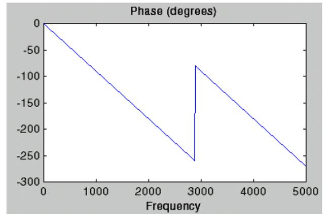
Resultierendes Amplituden- und Phasenspektrum am Ausgang des Filters:
